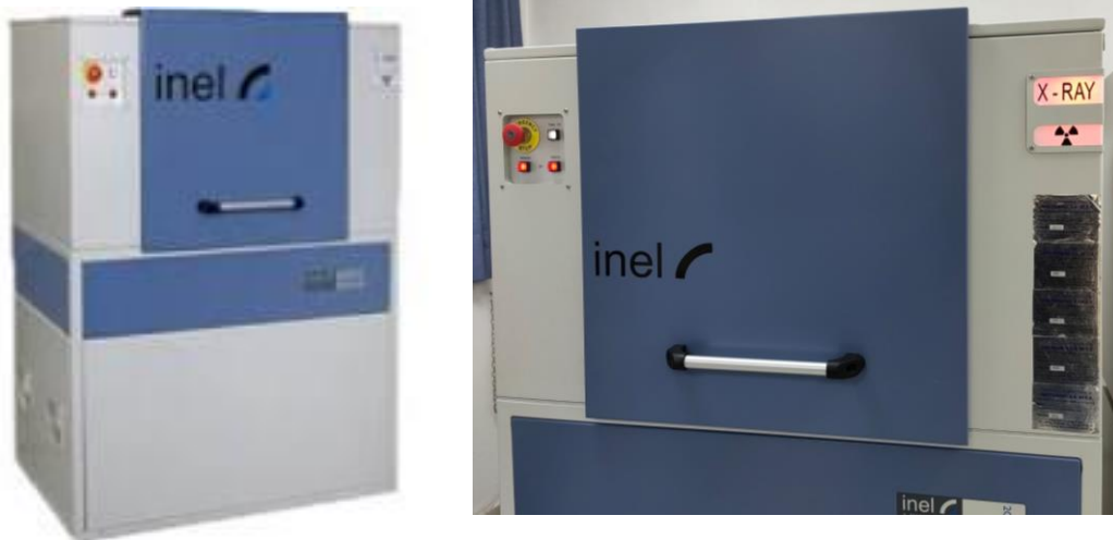
Difractómetro Inel, modelo EQUINOX 2000 Radiación con una lámpara de cobalto ( \text{CoK}_\alpha ) con una longitud de onda 1.78 \text{ \AA} .
